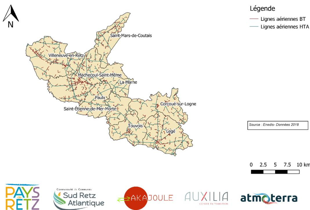
Figure 70 : Tracé du réseau de distribution d'électricité
