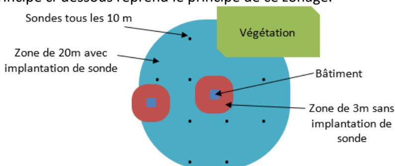
Il a ensuite été pris une hypothèse de production de 6 kW par sonde (capacité thermique du sol supposé à 30 W/ml sur des sondes de 200 m) et une production durant 2 000 h/an, soit une production moyenne de 12 000 kWh/an/sonde.
